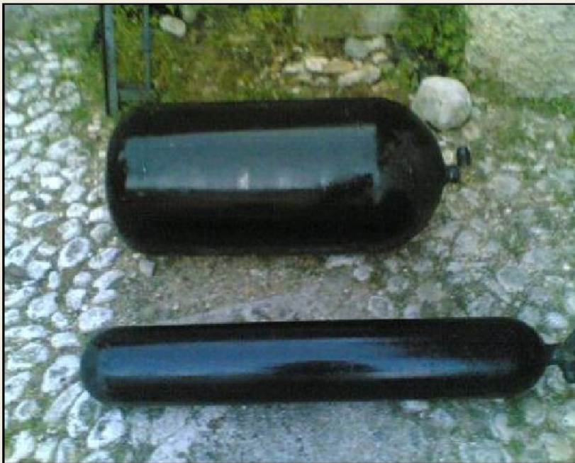
Serbatoi di metano compresso
